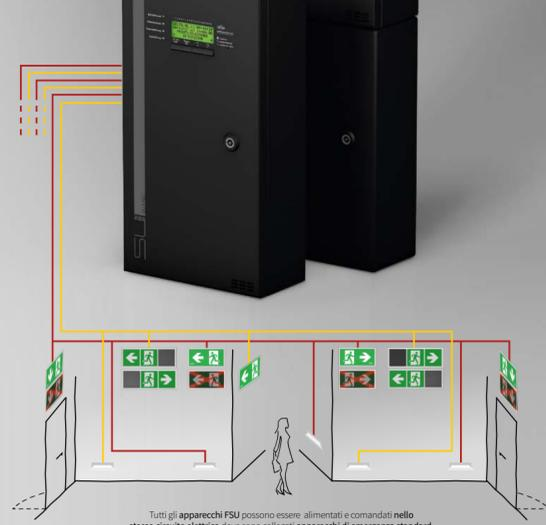
Tutti gli apparecchi FSU possono essere alimentati e comandati nello stesso circuito elettrico dove sono collegati apparecchi di emergenza standard.
