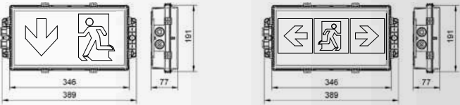
INDUSTRY Ex X32 RZ1 Laser-Pikto/X-Pikto Rettungszeichenleuchte temporär sichtbar und mit Sperrfunktion INDUSTRY Ex X32 RZ1 3tlg. Laser-Pikto/X-Pikto Rettungszeichenleuchte temporär sichtbar und mit Sperrfunktion, umschaltbar 3tlg.
