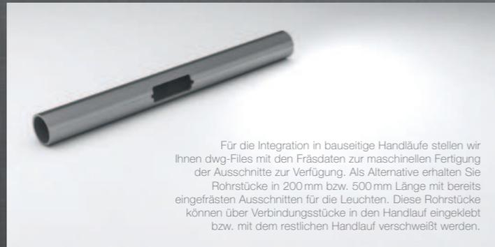
Für die Integration in bauseitige Handläufe stellen wir Ihnen dwg-Files mit den Fräsdaten zur maschinellen Fertigung der Ausschnitte zur Verfügung. Als Alternative erhalten Sie Rohrstücke in 200 mm bzw. 500 mm Länge mit bereits eingefrästen Ausschnitten für die Leuchten. Diese Rohrstücke können über Verbindungsstücke in den Handlauf eingeklebt bzw. mit dem restlichen Handlauf verschweißt werden.
